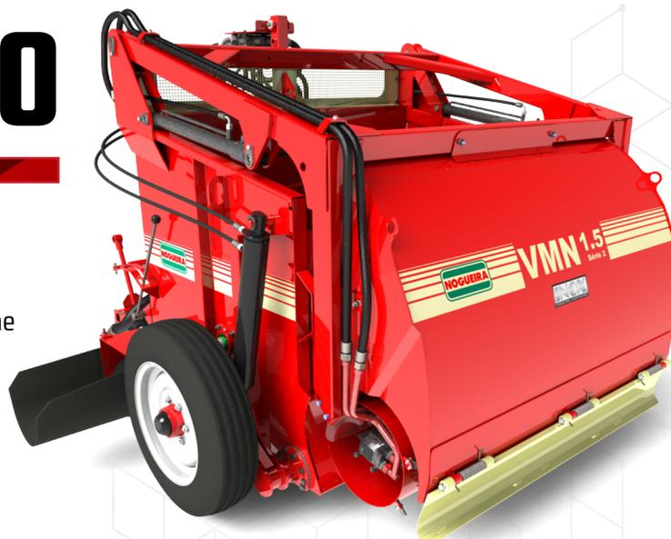
Mando hidráulico con movimiento de pantógrafo y desarme de seguridad.
