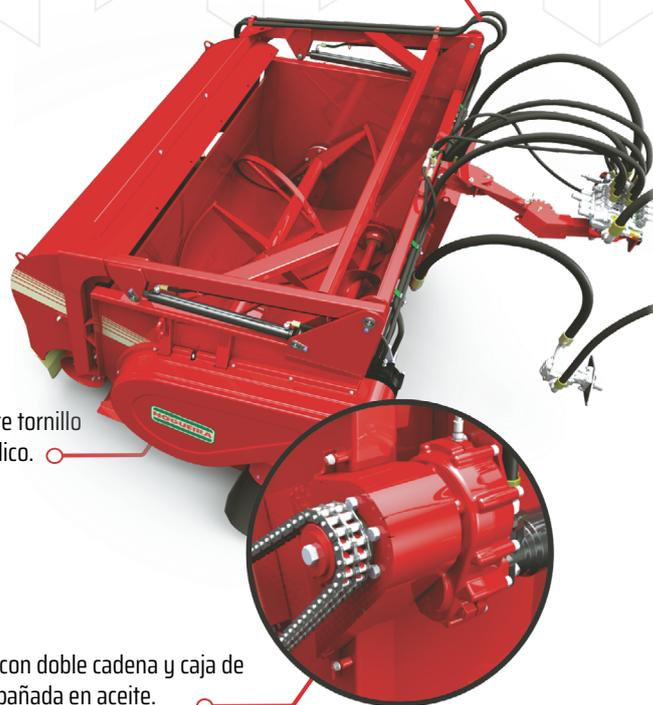
Transmisión con doble cadena y caja de transmisión bañada en aceite.
