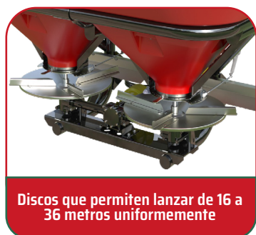
Ajuste automático de la apertura de los discos
