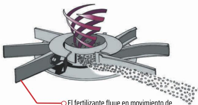
El fertilizante fluye en movimiento de rotación hacia las cuchillas
