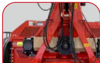
Sistema de enganche frontal o trasero
