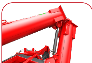
Junta de tubo descarga hidráulica
