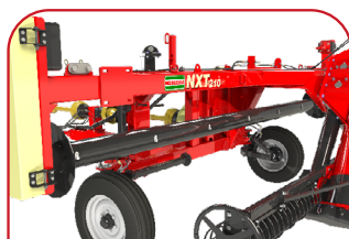
Sistema de elevación hidráulica para transporte de máquinas
