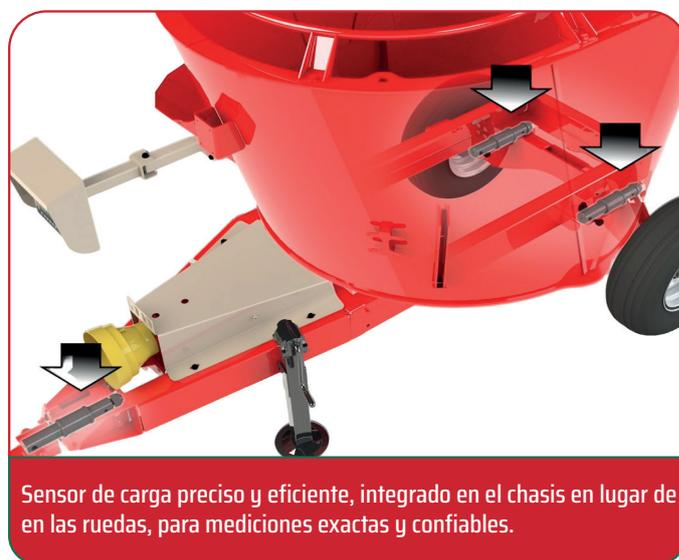
Sensor de carga preciso y eficiente, integrado en el chasis en lugar de en las ruedas, para mediciones exactas y confiables.
