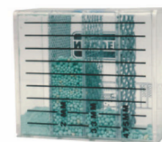
Caja de graduación para comprobar calidad de fertilizante
