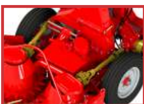
Duas rodas de apoio e eixo com pistões hidráulicos para levantar a máquina
