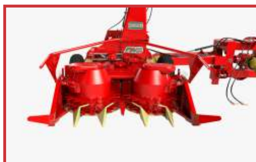
Frente de corte com 2 tambores de corte e largura de trabalho de 1,6 mt.
