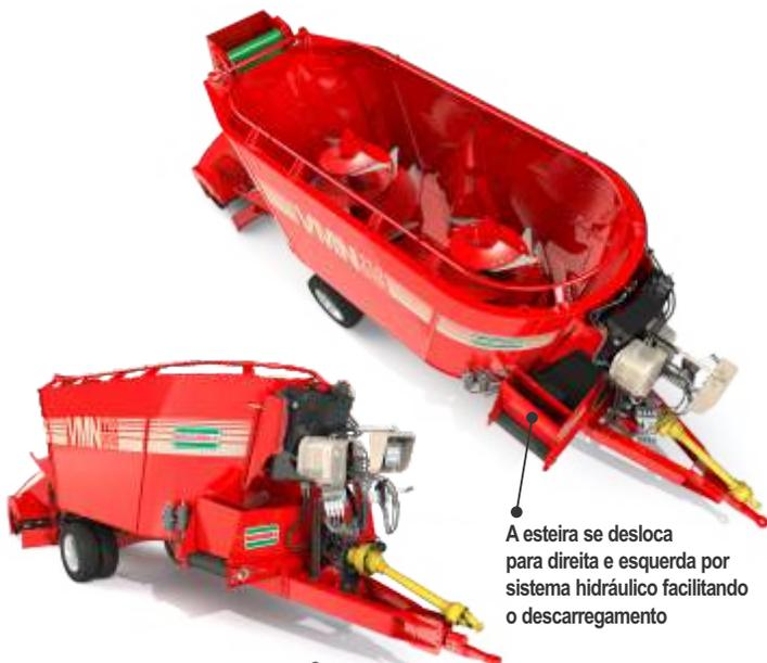
A esteira se desloca para direita e esquerda por sistema hidráulico facilitando o descarregamento
