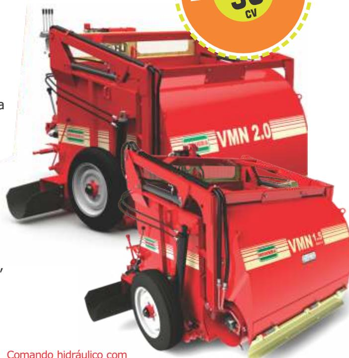
Facas intercambiáveis em aço especial e removíveis cortam o silo sem danificá-lo.
