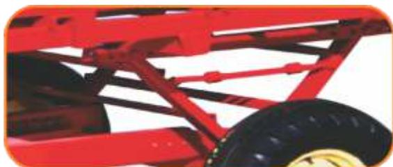
Sistema de regulagem que permite ajustar a altura de descarga de acordo com o cocho.
