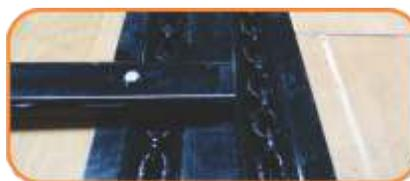
Corrente reforçada, em aço especial, com durabilidade e encaixe perfeito entre a corrente e a roda dentada com manutenção simples e rápida.
