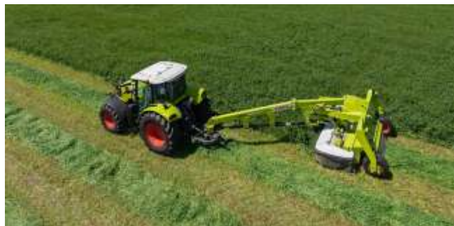
DISCO no arrasto com barra de tração central.
