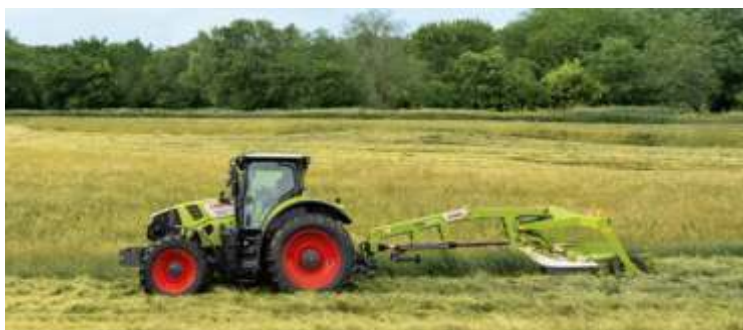
DISCO no arrasto com barra de tração central.
