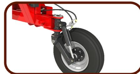
Sistema de levante hidráulico para transporte da máquina
