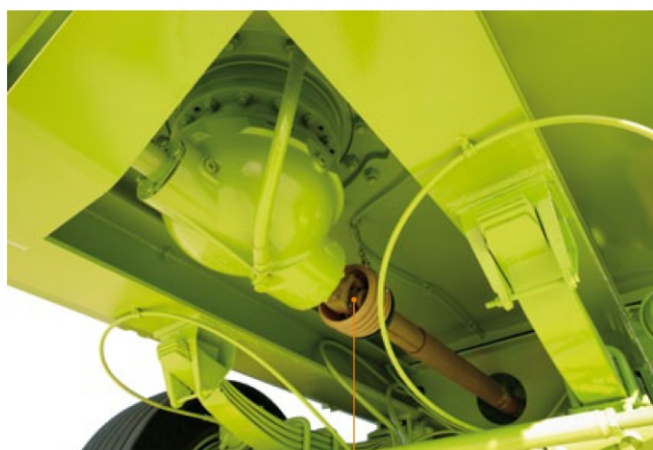
Riduttori standard dimensionati per impieghi particolarmente gravosi Standard gearboxes for heavy duty Reductores standard dimensionados para trabajos pesados
