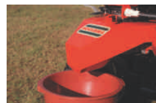
Kit de calibração Utilizado para fazer a calibração de vazão em ambos os discos.
